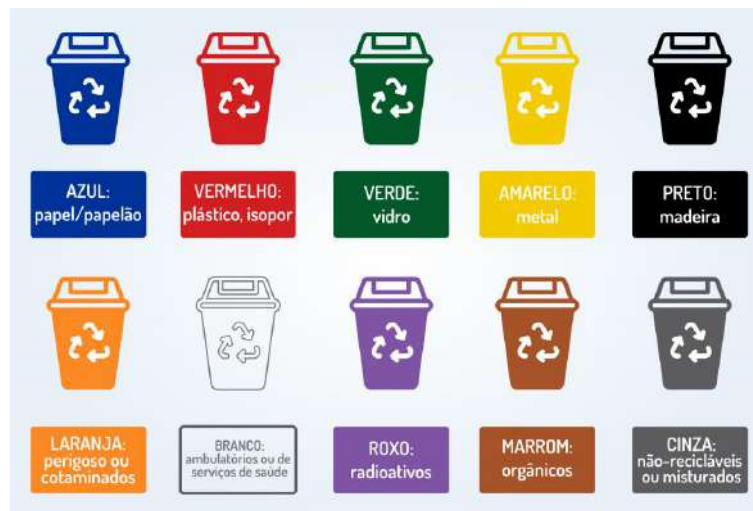
Figura 222: Código de cores para a coleta seletiva de diferentes tipos de resíduos, de acordo com o padrão estipulado pela Resolução CONAMA n° 275, de 2001
